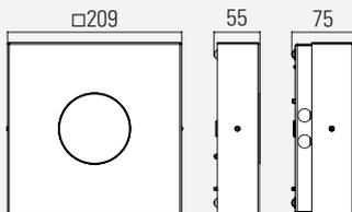
Seitliche Kabeleinführungen können durch Höhenverstellung freigelegt werden.
