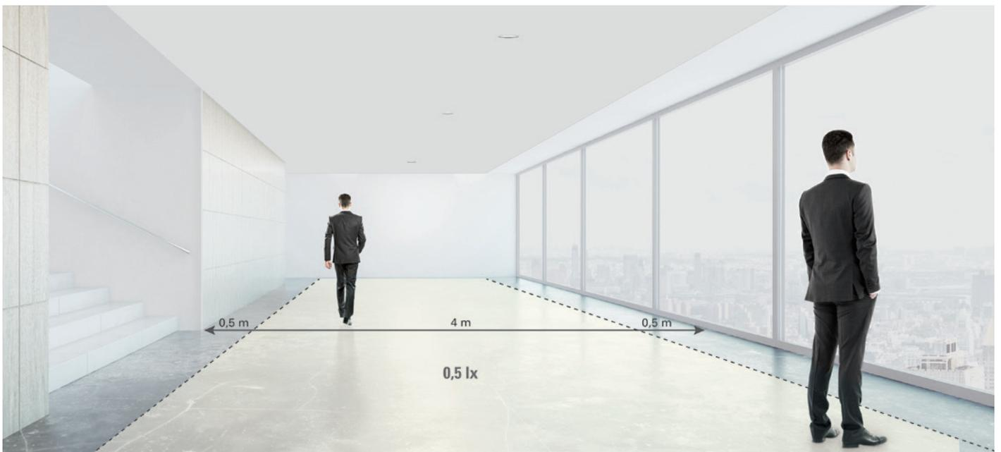
Gemäß DIN EN 1838 können breitere Rettungswege als mehrere 2 m breite Streifen betrachtet werden oder mit einer flächigen Antipanikbeleuchtung ausgerüstet werden. Wir empfehlen die Ausrüstung mit einer flächigen Antipanikbeleuchtung (0,5 lx).
