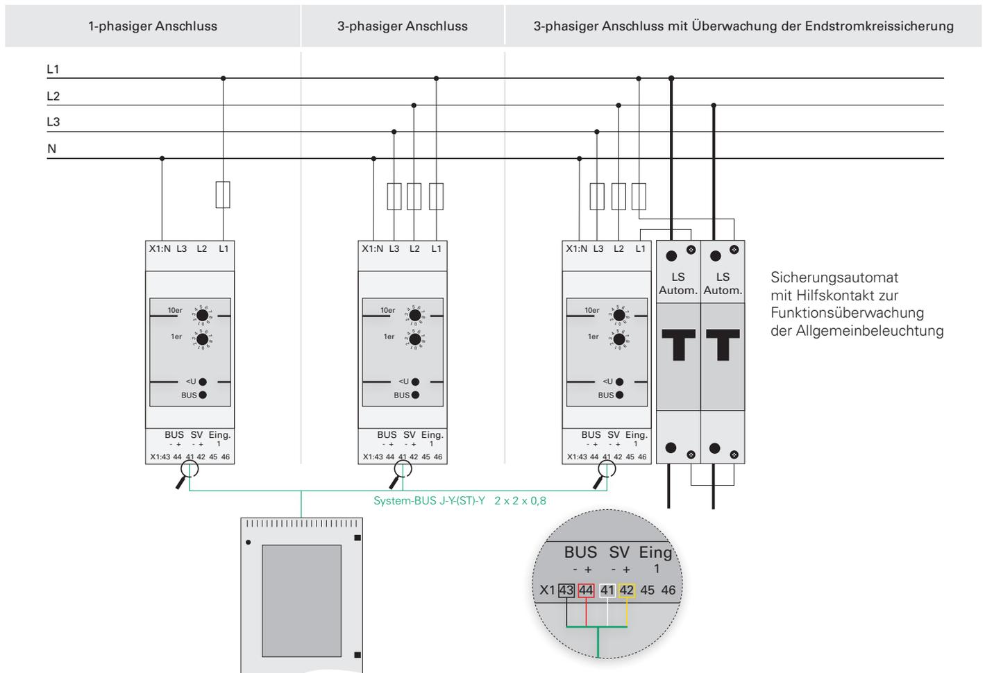
Sicherungsautomat mit Hilfskontakt zur Funktionsüberwachung der Allgemeinbeleuchtung
