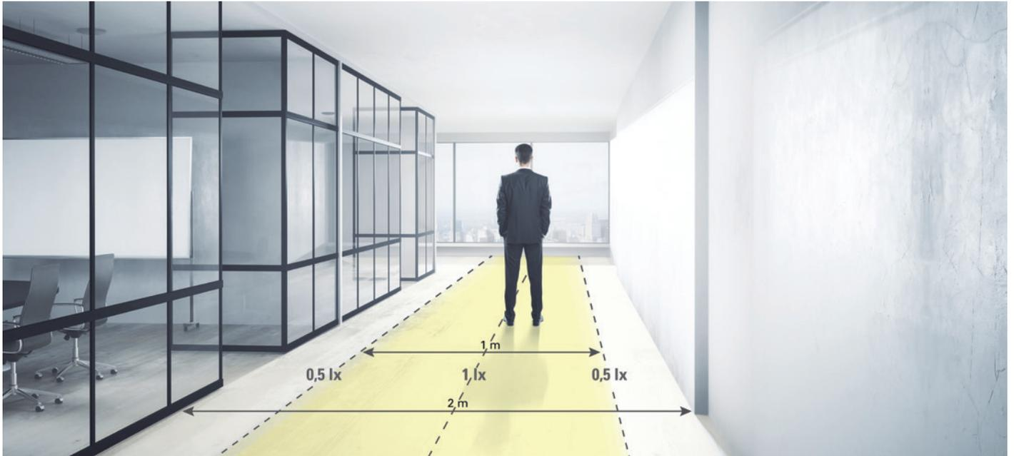
Bei Rettungswegen mit einer Breite von 2 m muss die Beleuchtungsstärke auf dem Boden entlang der Mittellinie mind. 1 Lux betragen. Der Mittelbereich, der nicht weniger als der Hälfte der Breite entspricht, muss mind. 0,5 Lux betragen.
