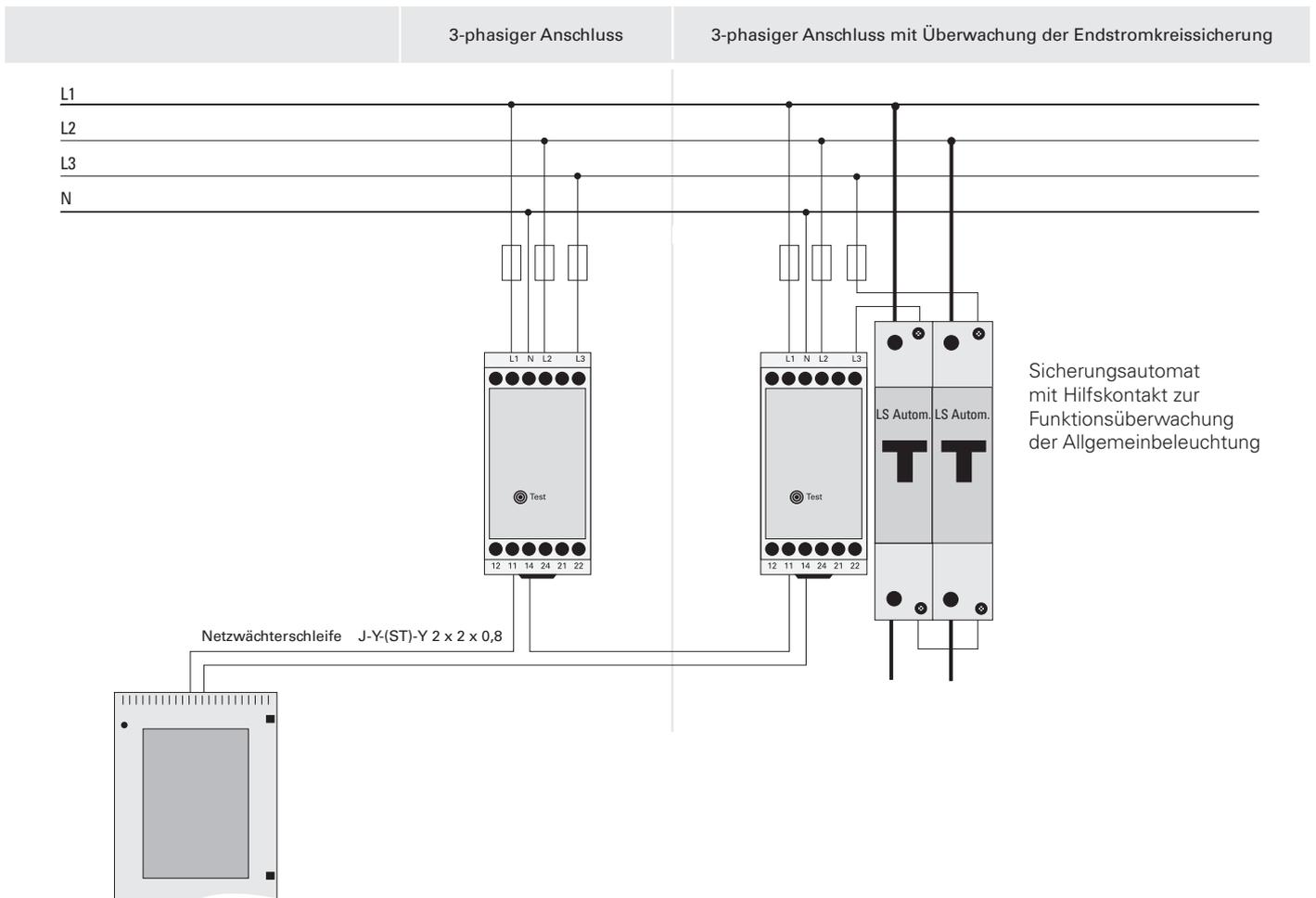
DNÜ-MB ist ein BUS-Phasenwächter, welcher zur Überwachung des AV-Netzes dient.
