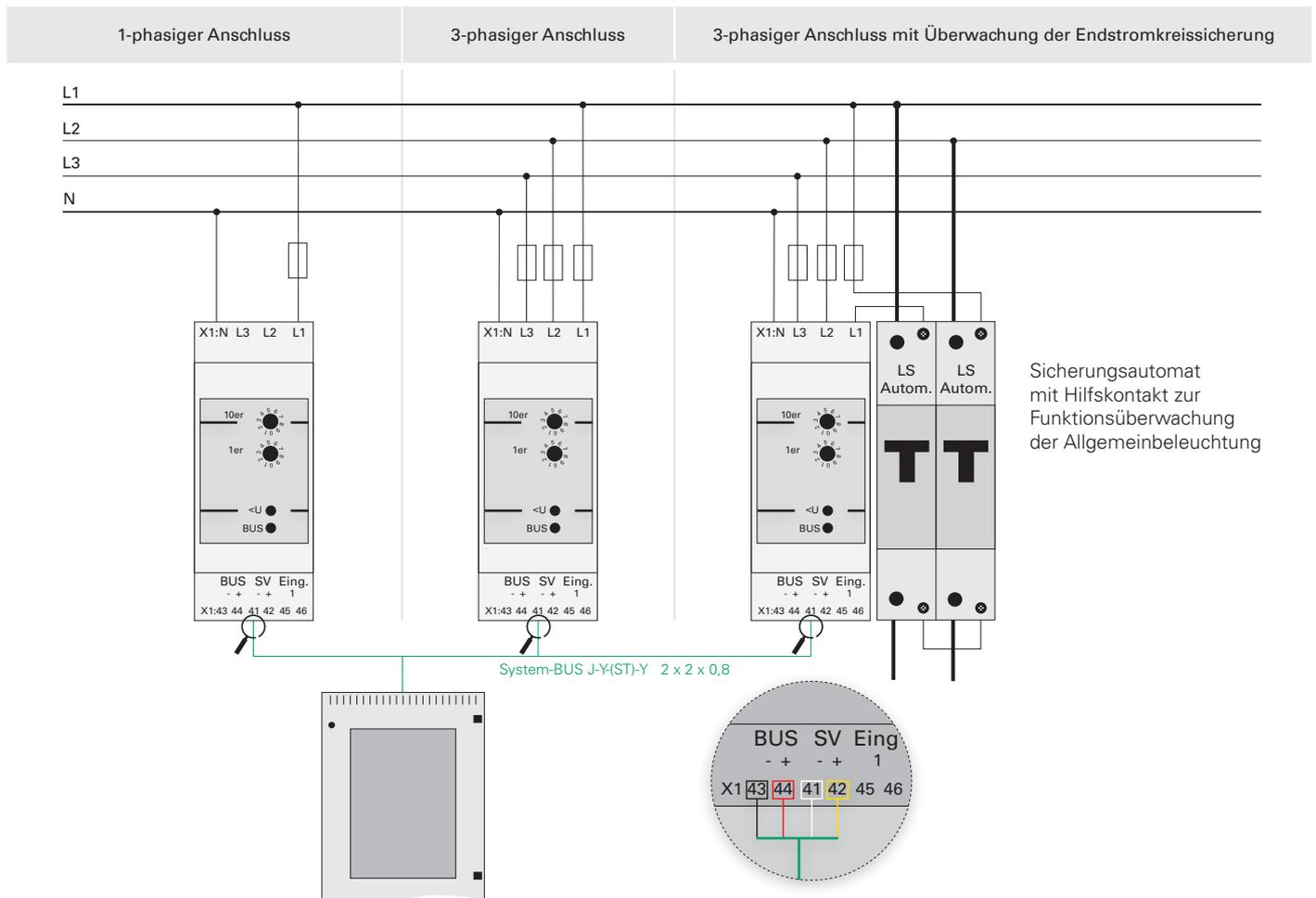
Sicherungsautomat mit Hilfskontakt zur Funktionsüberwachung der Allgemeinbeleuchtung
